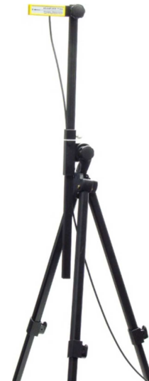
Abbildung 3: Sonde AS-UAP-IATA auf Stativ
