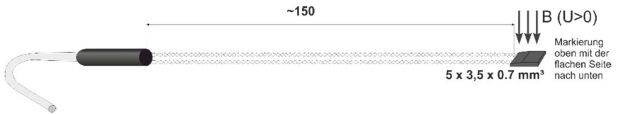
Abb. 82 Maße Transversalsonde 2000 mT (AS-NCu-Wire)
