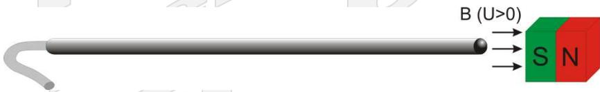
Abb. 39 Polarität Axialsonde
