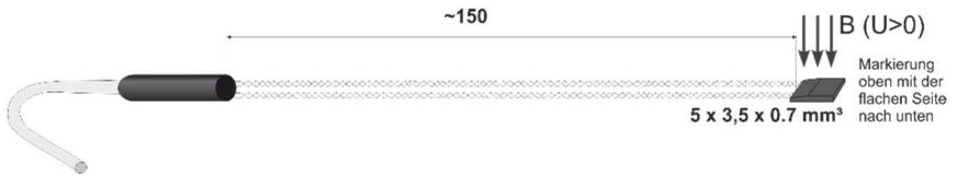
Abb. 82 Maße Transversalsonde 2000 mT (AS-NCu-Wire)
