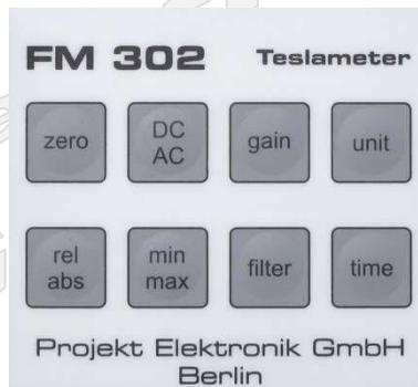
*Abb. 3 Tastatur des Teslameter FM 302*
