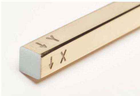
Abb. 4 Markierung der Messrichtung auf der Sonde
