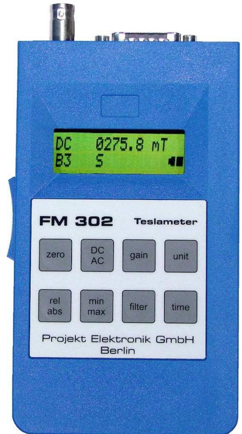
Das Teslameter FM 302 ist ein handliches Messgerät für alle unsere AS-Aktivsonden. Es misst die Magnetfelder über einen großen Anwendungsbereich. Dieser schließt Wechselfelder ebenso ein, wie magnetische Gleichfelder. Bei Wechselfeldern kann wahlweise der Mittelwert (DC) oder der Effektivwert (RMS) angezeigt werden.
