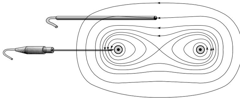
Abbildung 6: Feld bei zwei Leitern (gleichgerichtete Ströme)
