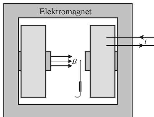
Abbildung 12: Elektromagnet mit Sonde zur Feldregelung
