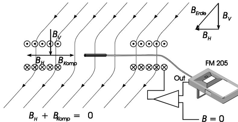
Abbildung 11: Kompensation des Erdmagnetfeldes
