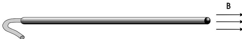
Abbildung 7: positive Feldrichtung Axialsonde
