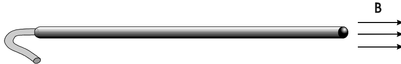
Abbildung 7: positive Feldrichtung Axialsonde
